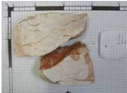
2,3. Attività diagnostica. Durante le ispezioni è risultato necessario rimuovere alcuni elementi in fase di distacco pericolosi per la pubblica incolumità. I 41 elementi distaccati sono stati numerati, raccolti all'interno di singoli sacchetti e successivamente ricollocati. Il numero di ogni elemento è stato riportato nelle mappature dello stato di conservazione.
